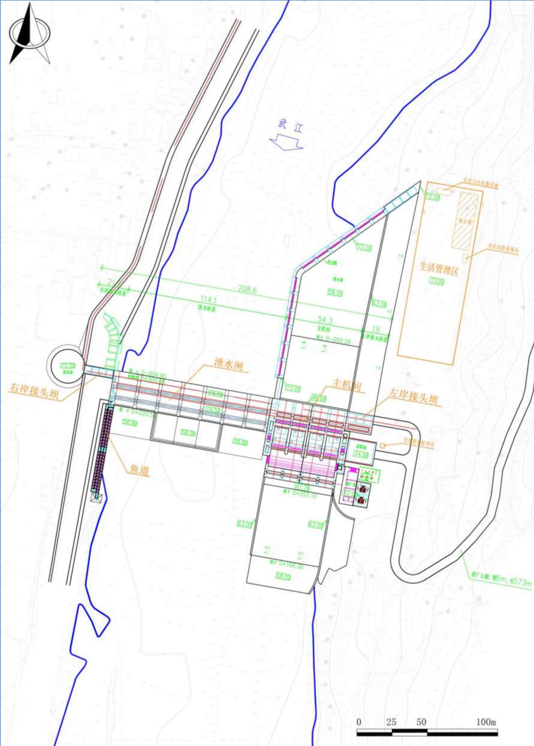
图 3.2-2 项目枢纽工程总平面图
